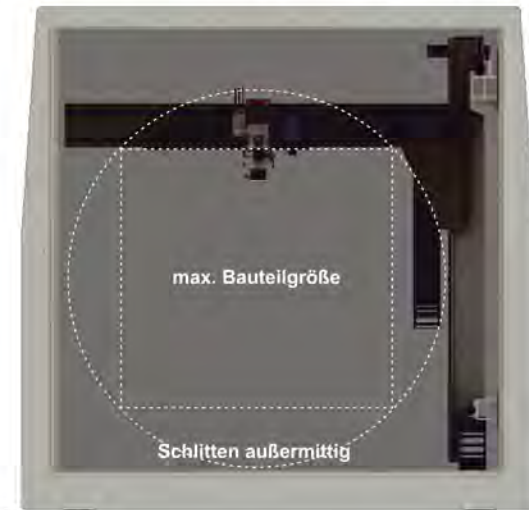
Bauform C: Seitenwand-Längsfahrwerk mit vertikal verfahrbarem Querfahrwerk mit Generator mit integrierter Dreh- und Schwenkachse
