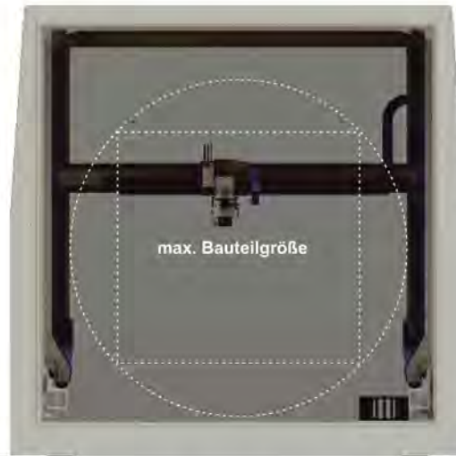
Bauform B: Portal-Längsfahrwerk mit vertikal verfahrbarem Querfahrwerk und Generator mit integrierter Dreh- und Schwenkachse
