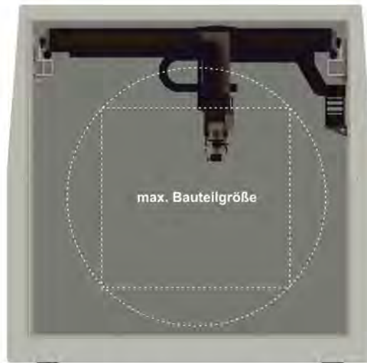
Bauform A: Brücken-Längsfahrwerk mit Querfahrwerk und Generator mit integrierter Dreh- und Schwenkachse auf Teleskop-Vertikalfahrwerk
