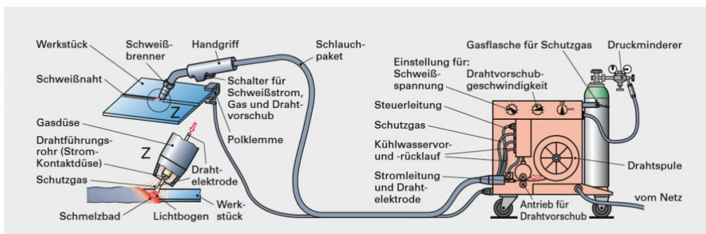
Grafik: Metallschutzgasschweißen © Fachkunde Metall, 58. Auflage 2017, Verlag Europa-Lehrmittel
