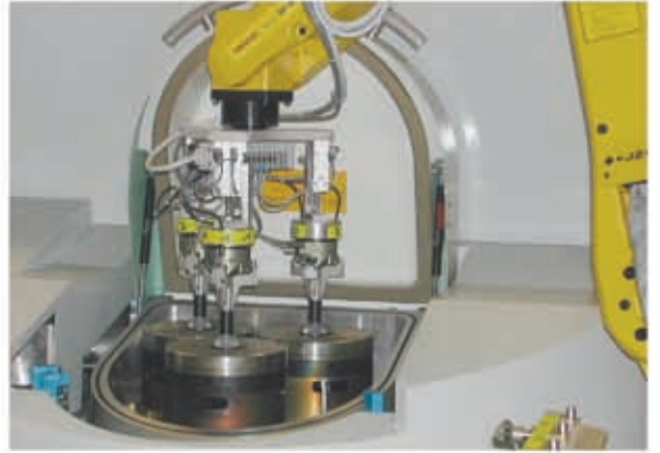
向一个三主轴系统中装载涡轮增压器零件
